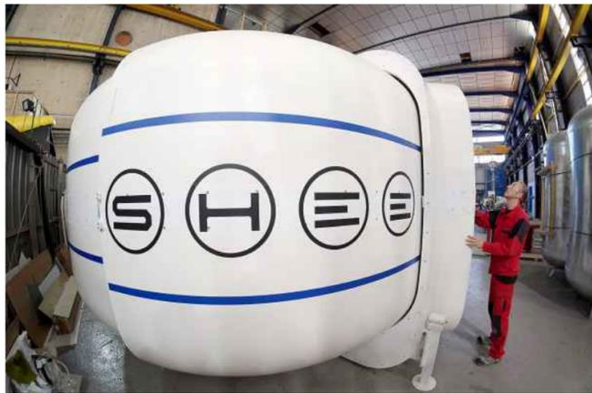
Ein SHEE-Modul (Self-deployable Habitat for Extreme Environments) bei Tests in Marseille.
